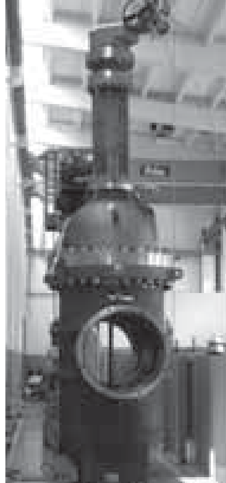
Valvola through-conduit 40" per il progetto ESPO in Siberia - Russia.
