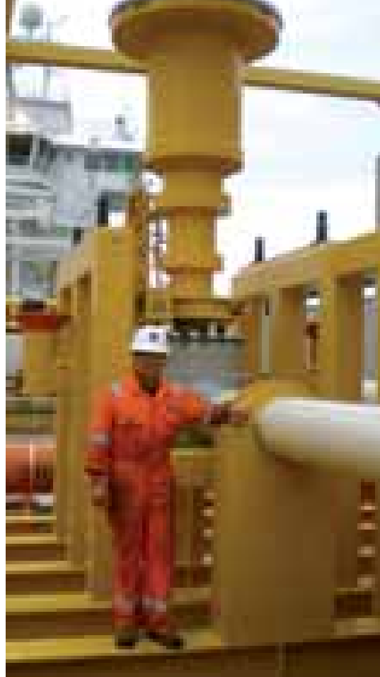
Valvola a sfera top-entry sottomarina sulla nave pronta per l'installazione in mare- progetto Gjoa - Norvegia.
